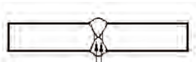
نفوذ ناقص در اتصالات شیاری دو طرفه
